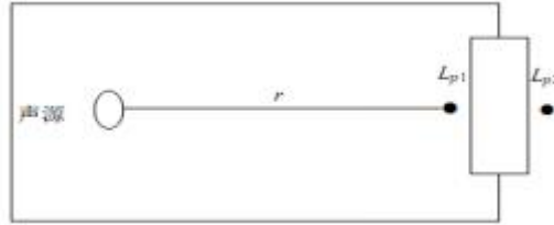
图 7-1 室内声源等效为室外声源图例
